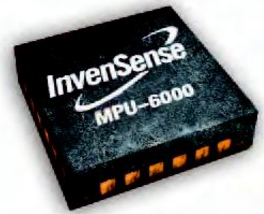
Bild 1: Der MPU-6000 integriert 3-Achsen Gyroskop und 3-Achsen Beschleunigungssensor im 4 x 4 mm großen Gehäuse.
