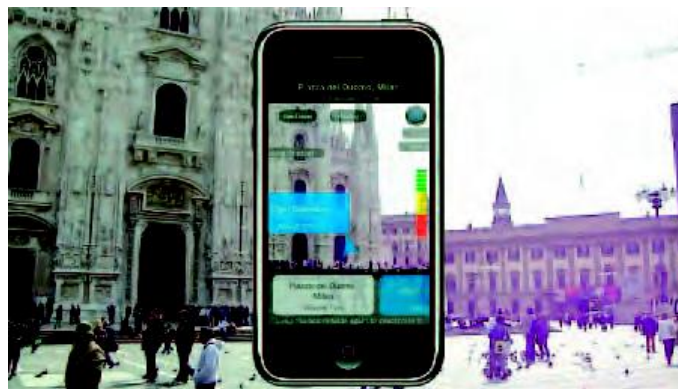
Bild 3: Anwendungsbeispiel „Augmented Reality“: Die Sensorik muss recht präzise Position und Ausrichtung des Smart-Phones im dreidimensionalen Raum erfassen.
