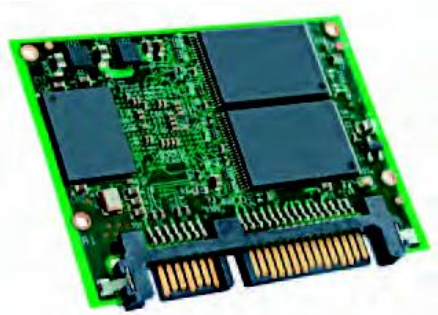
Bild 2: Embedded iSATA FLASH-Drive – das Laufwerk kann entweder direkt in den SATA-Connector einer Baugruppe gesteckt werden oder über Kabel verbinden.
